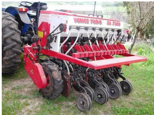
Foto 2. Máquina cero labranza Marca Vence Tudo de fabricación brasileña de enganche integral, equipada con disco liso doble desfasado, lo que mejora el corte del rastrojo.
