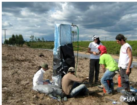
Yağmur simülasyonu (arazi kullanımı: çalı)
